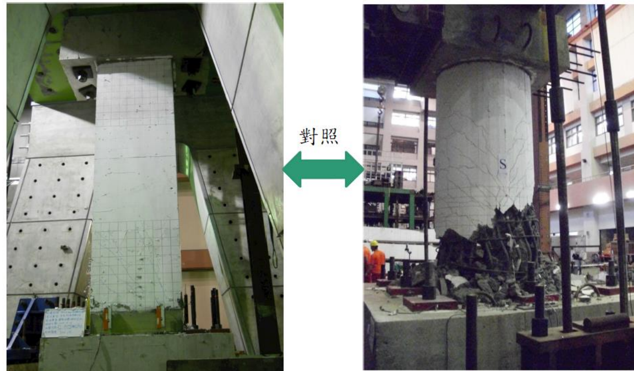
70mm位移, 相當於400gal以上地震力測試後柱體依然沒有遭受撓剪破壞, 結構完整
